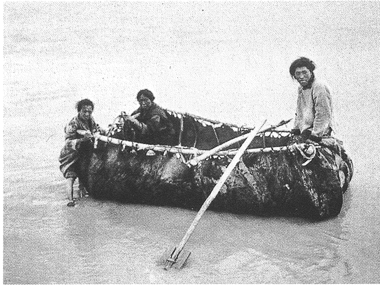
図8 コワ。柳の枝を編んだ骨組みにヤクの皮を張って作るもので、渡河や物資の運搬に威力を発揮する。〔SNELMGROVE & RICHARDSON 1980 : 168〕
